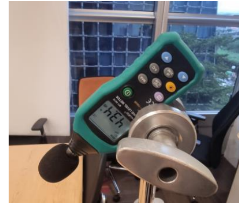
Fan Speed 1800rpm – 43.4dBA
