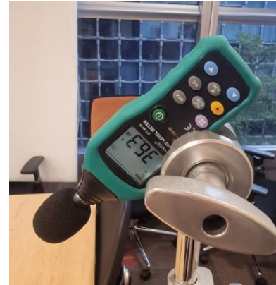
Fan Speed 900rpm – 36.3dBA
