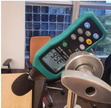
Fan Speed 600rpm – 35.6dBA
