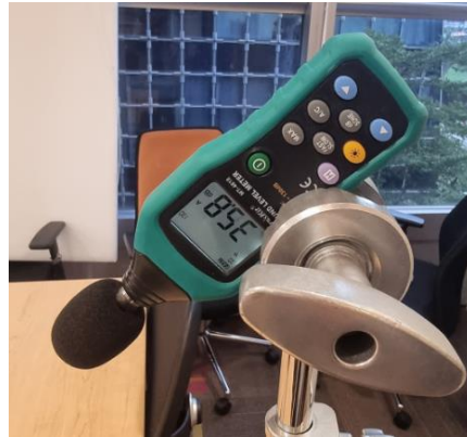
Fan Speed 700rpm – 35.8dBA
