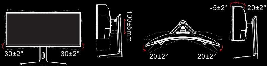
2.1 螢幕可以做前傾後仰和上下高度調節，具體調整角度依不同機型而定，一般為前傾 $5\pm 2$ 度，後仰 $20\pm 2$ 度。
