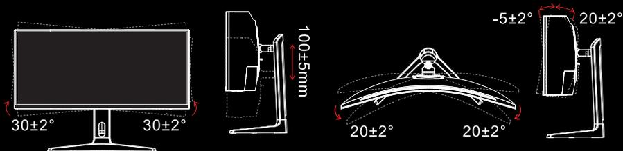
2.1 萤幕可以做前倾后仰和上下高度调节，具体调整角度依不同机型而定，一般为前倾 $5\pm 2$ 度，后仰 $20\pm 2$ 度。
