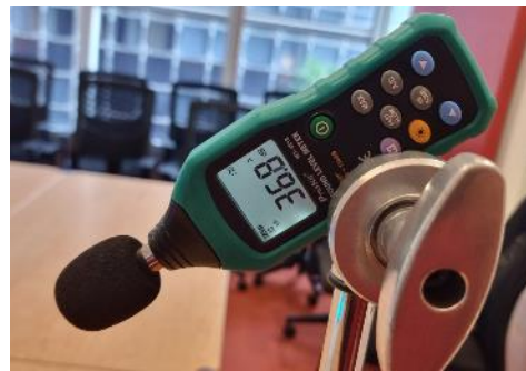
Fan Speed 550rpm – 36.8dBA
