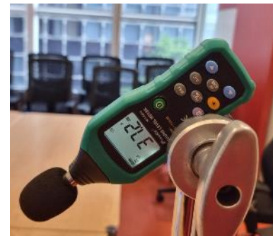
Fan Speed 750rpm – 37.2dBA
