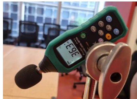
Fan Speed 400rpm – 36.3dBA
