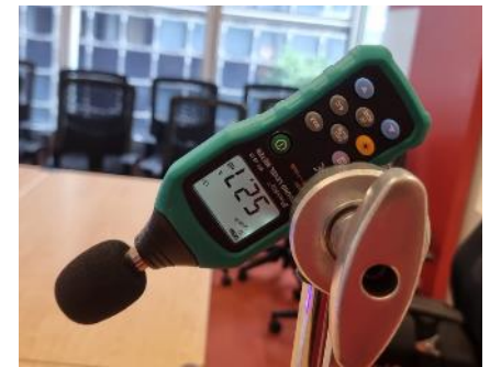
Fan Speed 2000rpm – 52.7dBA
